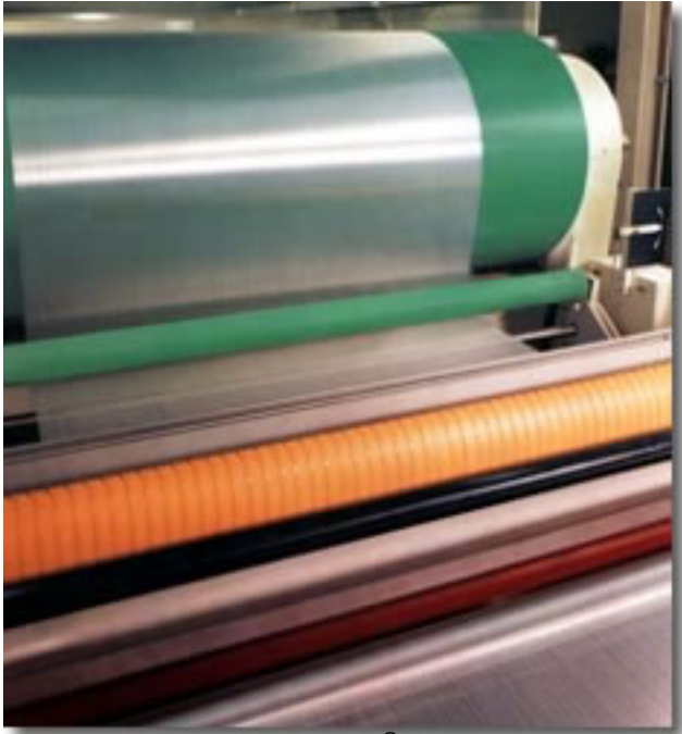
Trichterzylinder in einer Schlichtmaschine
